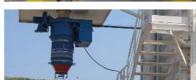
Extraction by screw conveyors and loading bellow. Extracción por tornillo sinfín y manga retráctil.
