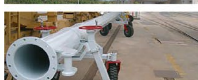
Detail of mobile fill pipe. Detalle de tubería de llenado móvil.
