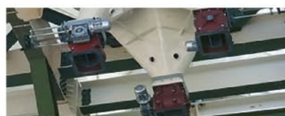
Silo with 3 outlets cone Silo con cono de 3 salidas.
