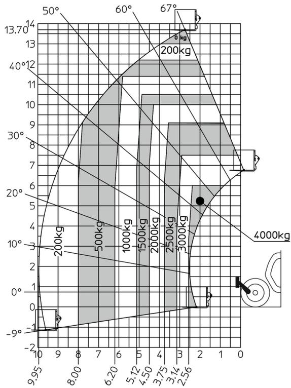
Máquina sobre estabilizadores con horquillas
