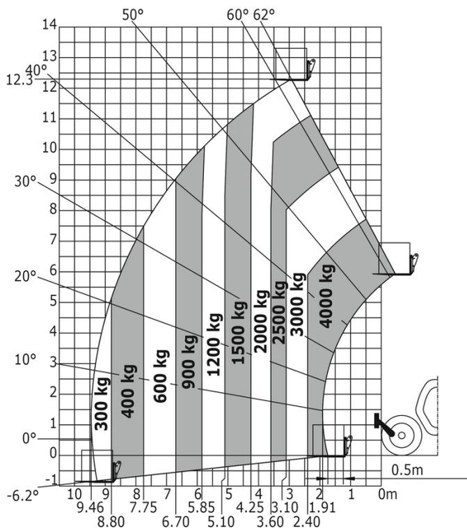
Máquina sobre estabilizadores con horquillas
