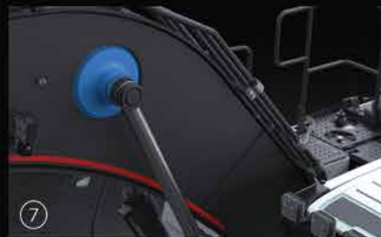
⑦ Cojinete del cilindro de la pluma de fundición reforzada
